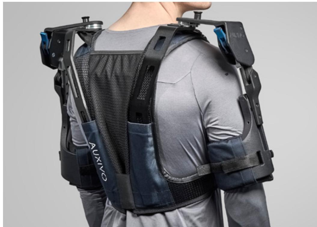
Das Split-Westen-Design gewährleistet eine hohe Bewegungsfreiheit und dient als Schnittstelle zwischen Nutzer und mechanischer Struktur.
